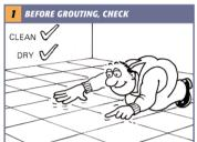
1 THIN COAT OF MN SLATE-SEAL BEFORE GROUTING
